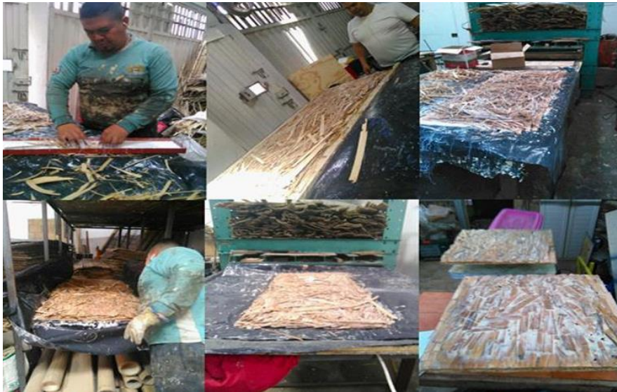
Figura 2.4.1. Proceso de fabricación del tablero. Empresa MUISKAY
