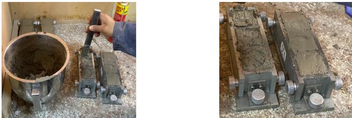
Figura 2.12. Compactación en moldes metálicos. Bueno & Pulla, 2024.
