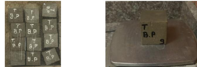
Figura 2.13. Muestra de mortero en proceso de curado. Bueno & Pulla, 2024.
