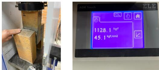
Figura 2.84. Murete M4 y carga máxima. Bueno & Pulla, 2024.
