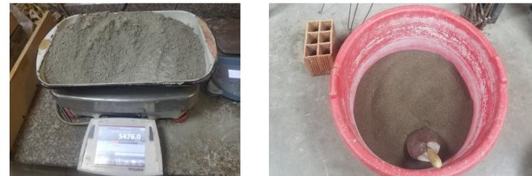
Figura 2.10. Muestra de cemento y muestra de arena según cálculo de dosificación. Bueno & Pulla, 2024.
