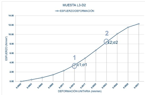
Figura 2.41. Gráfica experimental esfuerzo y deformación L3D2. Bueno & Pulla, 2024.
