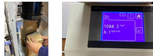
Figura 2.78. Murete M1 y carga máxima. Bueno & Pulla, 2024.
