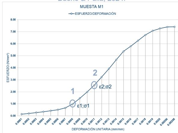
Figura 2.61. Gráfica experimental esfuerzo y deformación M1. Bueno & Pulla, 2024.
