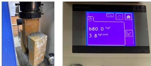
Figura 2.80. Murete M2 y carga máxima. Bueno & Pulla, 2024.
