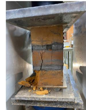
Figura 2.16. Murete de ladrillo panelón y mortero sometido a esfuerzo a compresión. Bueno & Pulla, 2024.
