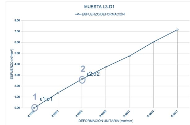
Figura 2.39. Gráfica analítica esfuerzo y deformación L3D1. Bueno & Pulla, 2024.
