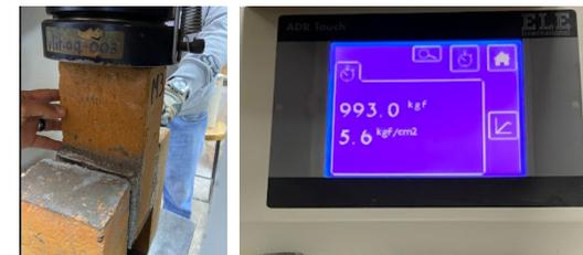
Figura 2.82. Murete M3 y carga máxima. Bueno & Pulla, 2024.
