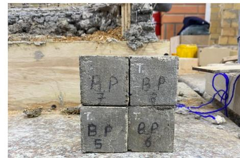
Figura 59. Cubos de mortero sometido a ensayo de compresión en laboratorio. Bueno & Pulla, 2024.
