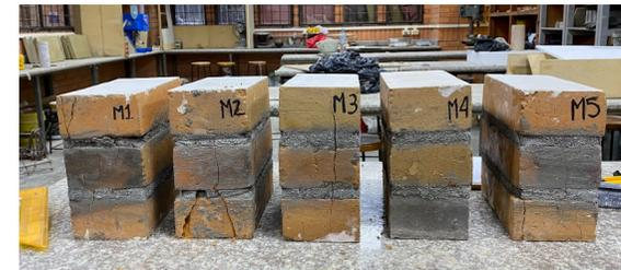
Figura 2.60. Cinco muretes sometidos a ensayo de compresión, Bueno & Pulla, 2024.
