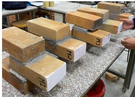
Figura 2.76. Cinco muretes sometidos a ensayo de esfuerzo a cortante. Bueno & Pulla, 2024.
