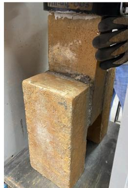
Figura 2.24. Murete de ladrillo panelón y mortero sometido a esfuerzo de adherencia. Bueno & Pulla, 2024.
