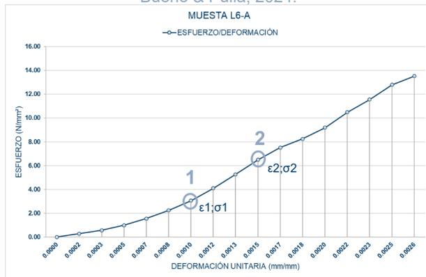
Figura 2.50. Gráfica experimental esfuerzo y deformación L6A. Bueno & Pulla, 2024.
