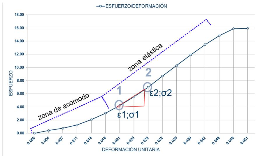
Figura 2.26. Gráfica esfuerzo y deformación unitaria para cálculo de módulo de Yong. Bueno & Pulla, 2023.
