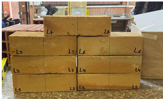
Figura 2.06. Muestras de ladrillo panelon, Bueno & Pulla, 2024.
