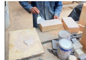
Figura 2.08. Proceso de refrentado de ladrillos panelón, Bueno & Pulla, 2024.
