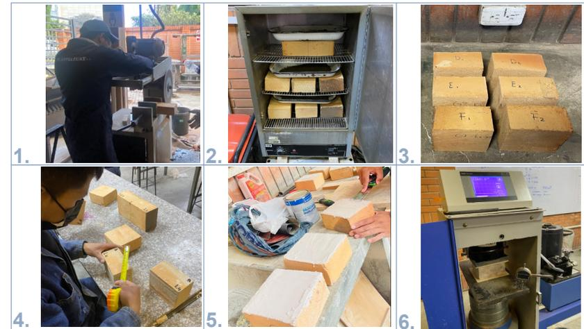
Figura 2.09. Procedimiento de ensayo a compresión de ladrillo panelón. Bueno & Pulla, 2024.
