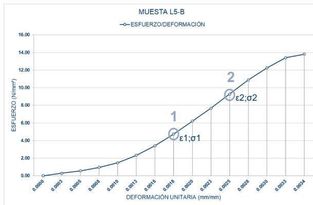
Figura 2.47. Gráfica experimental esfuerzo y deformación L5B. Bueno & Pulla, 2024.
