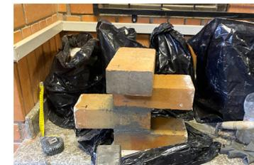
Figura 2.23. Sellado y curado de muretes de ladrillos. Bueno & Pulla, 2024.
