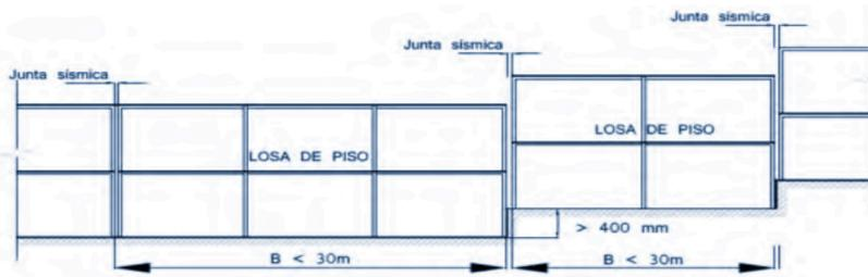
Figura 1.16. Juntas constructivas de casas adosadas, NEC-SE-DS-VIVIENDA, 2015.
