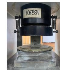
Figura 2.14. Muestra de mortero sometida a esfuerzo a compresión. Bueno & Pulla, 2024.
