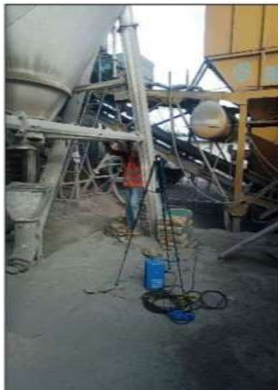
Fotografía 1: Monitoreo de contaminantes químicos realizado en AB-01: Tolva Cemento
