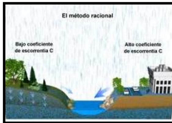
Fig.14. Incidencia del coeficiente de escorrentía en el método racional.
