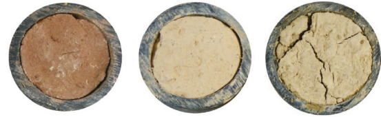
IMG-1.16 Ensayos para una tierra adecuada para la construcción
