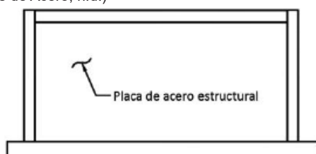
IMG-2.14 Pórticos de paredes de cortante con placa de acero
