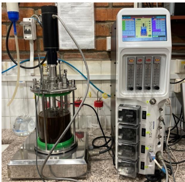
Figura 8. Biorreactor tipo Batch Biotron GX utilizado durante la hidrólisis enzimática ácida y la fermentación para obtención de bioetanol.
