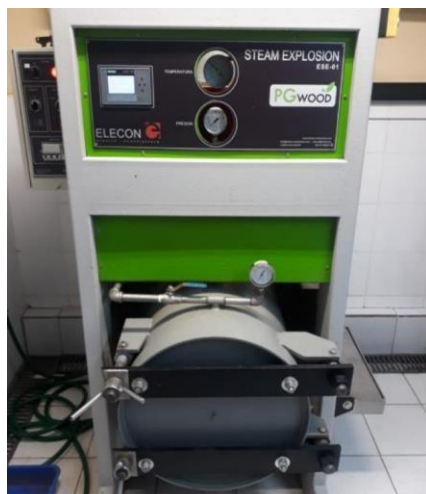
Figura 4. Equipo para explosión de vapor utilizado para el pretratamiento de biomasa lignocelulósica. Marca PG-WOOD Elecon.
