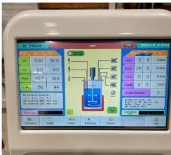
Figura 6. Fotografía de la pantalla mostrando las condiciones de operación y de tiempo real, usada en todas las hidrólisis realizadas.
