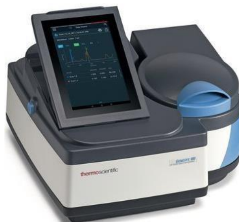
Figura 7. Espectrofotómetro UV-visible para cuantificación de azúcares totales (Método de Dubois).
