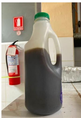
Figura 13. Residuo líquido obtenido mediante recirculación con vapor a 180 °C.
