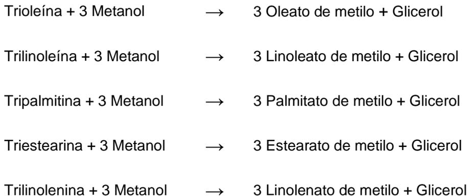
El setup generado para esta especificación se encuentra en el mismo bloque variable REACTOR (Rstoic) al dirigirse a su apartado Reactions (**figura 14**), sólo entonces se podría colocar la conversión fraccional que tiene cada uno de los triglicéridos del ACEITE a FAME, la estequiometría y la referencia por cada una de las reacciones químicas a desarrollarse en la operación unitaria respectiva.
