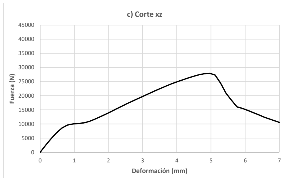
Figura 32. Curva fuerza-deformación para corte en (a)XY, (b)ZY y (c)Z X Los resultados numéricos para corte necesarios para la homogenización son los resultados de los módulos de corte en X, Y y Z (Tabla 17).
