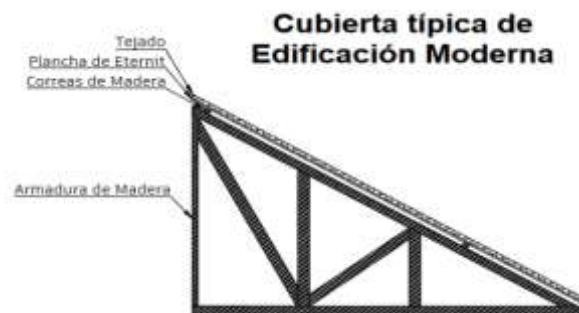
Figura 43. Esquema de una cubierta típica de edificación moderna (Arcentález & Pizarro, 2023)
