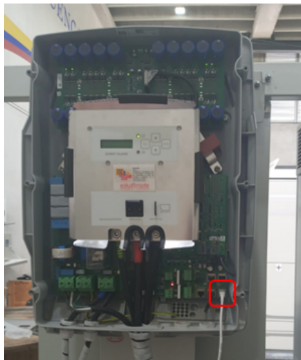
Figura A.3: Localización del puerto ComSmaIn en el inversor
