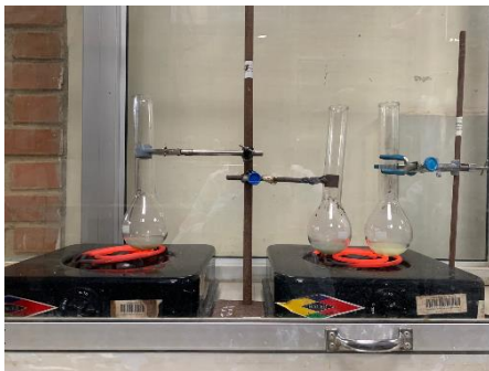
F5. Determinación de proteínas (digestión)
