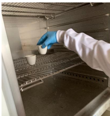
F1. Determinación de Humedad (I)
