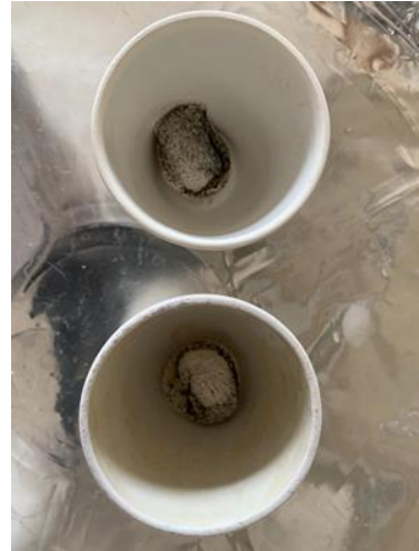
F4. Determinación de cenizas (II)
