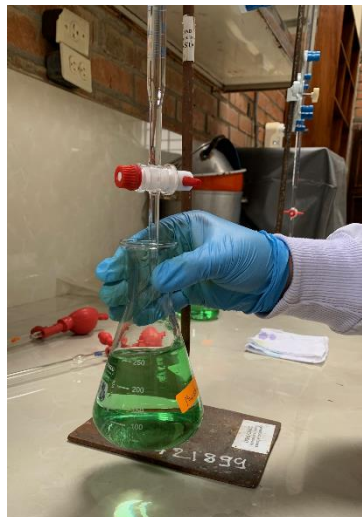
F7. Determinación de proteínas (valoración)
