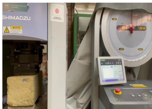
Figura 20. a). Esquema de ensayo a flexión; b). Ensayo a flexión, laboratorio
