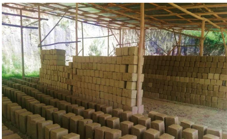
Figura 6. Secado y apilado de bloques de adobe
