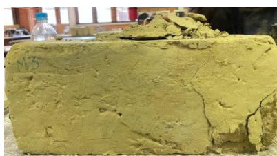
Figura 63. a). Resultado de ensayo a compresión de bloques de adobe en la simulación numérica; b)., c). y d). Resultados de ensayo a compresión de bloques de adobe en laboratorio
