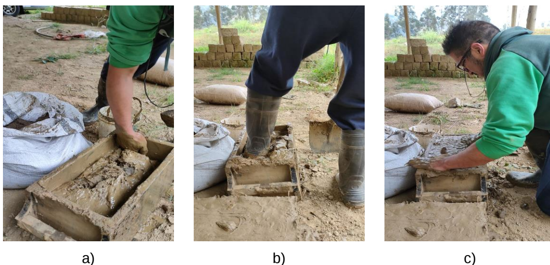
Figura 5. a). Compresión de tierra en molde de madera con las manos; b). Compresión de tierra en molde de madera con los pies; c). Desmoldeado de adobes
