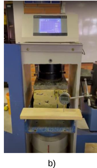
Figura 9. a). Esquema de ensayo a compresión; b). Ensayo a compresión, laboratorio
