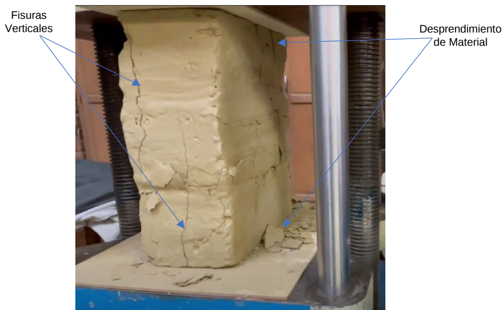
Figura 28. Ensayo a compresión de murete
