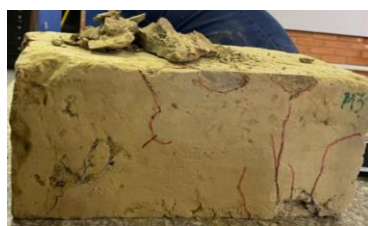
Figura 63. a). Resultado de ensayo a compresión de bloques de adobe en la simulación numérica; b)., c). y d). Resultados de ensayo a compresión de bloques de adobe en laboratorio
