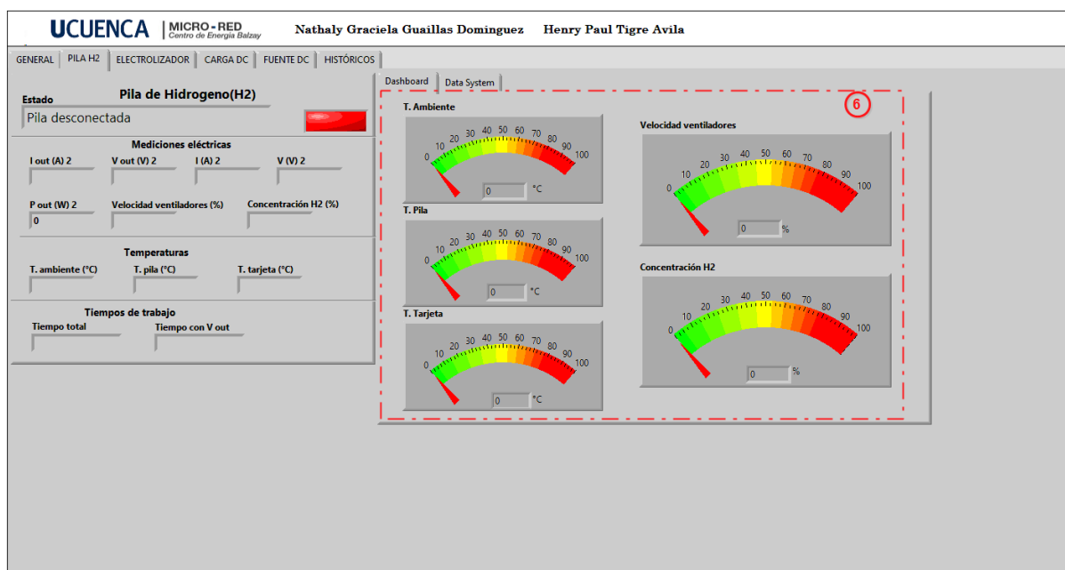
Figura 3.30: Panel de la pila de hidrógeno en el sistema SCADA 2/2.
