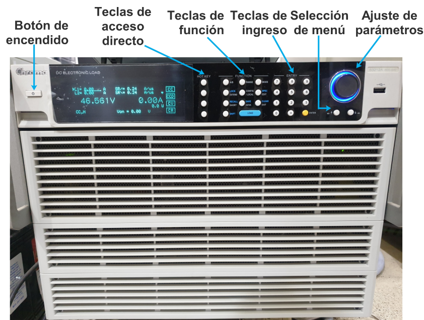
Figura 3.6: Panel frontal de la carga programable DC.
