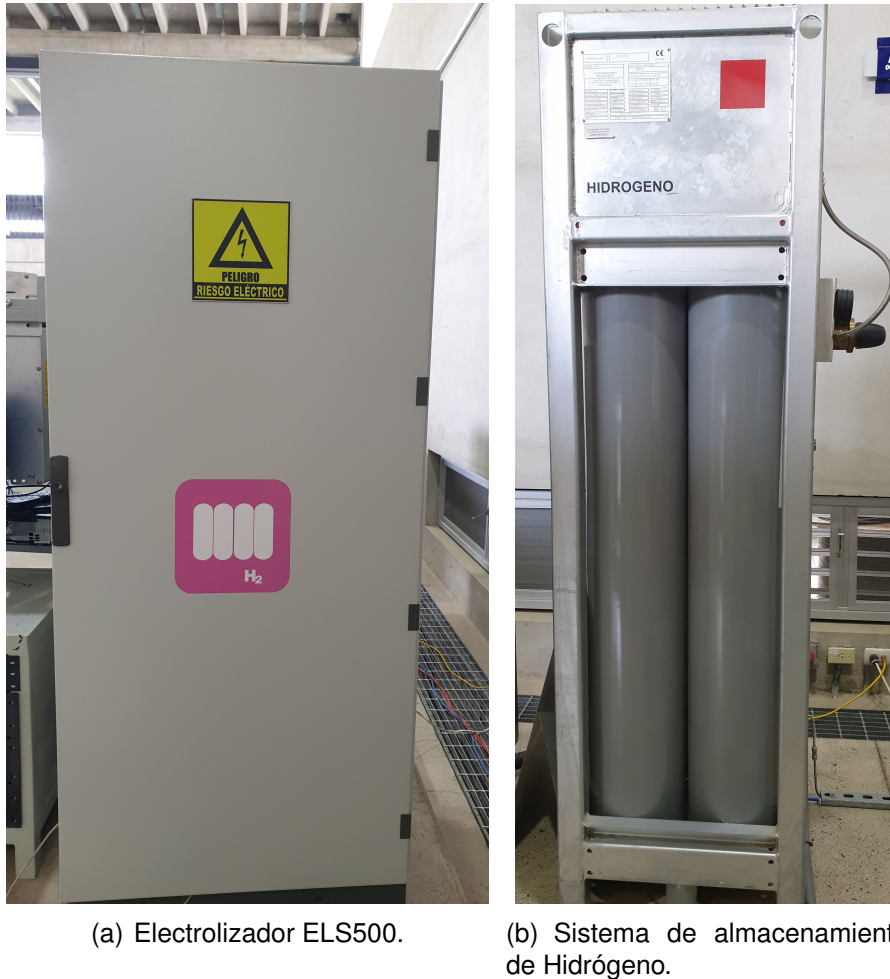
Figura 3.2: Electrolizador Heliocentris modelo ELS500.
