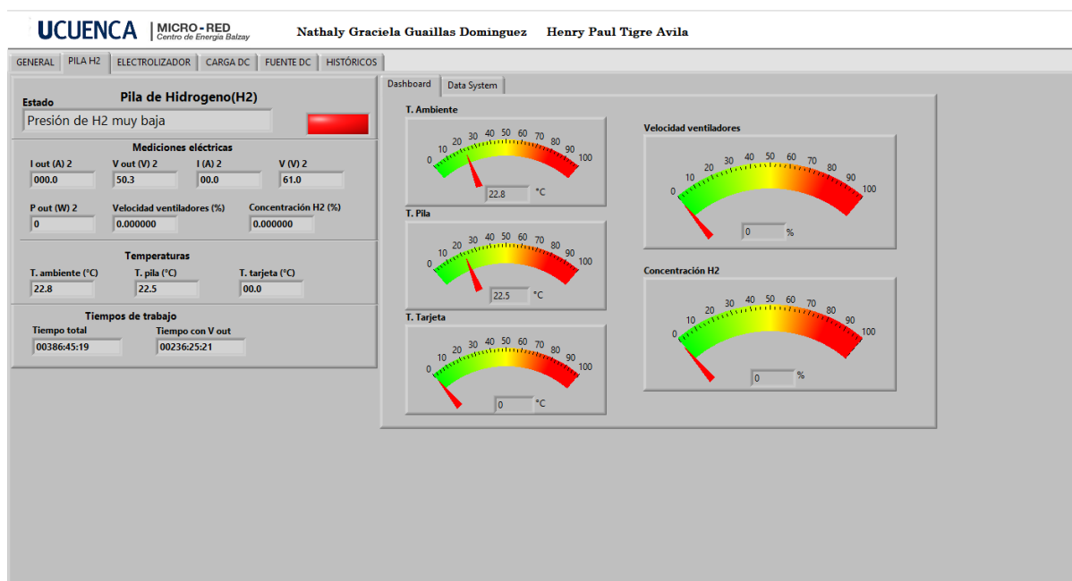
Figura 4.5: Panel de la pila de hidrógeno con error en su operación
