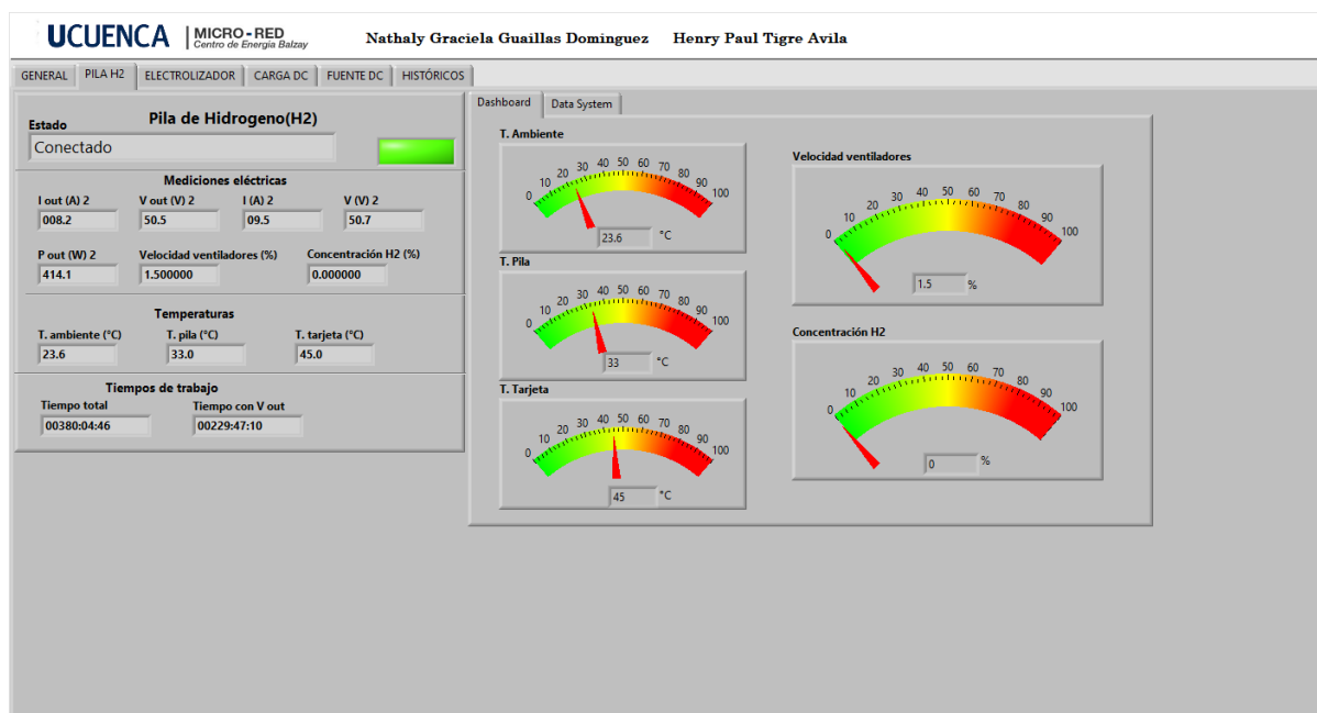
Figura 4.5: Panel de la pila de hidrógeno con error en su operación
