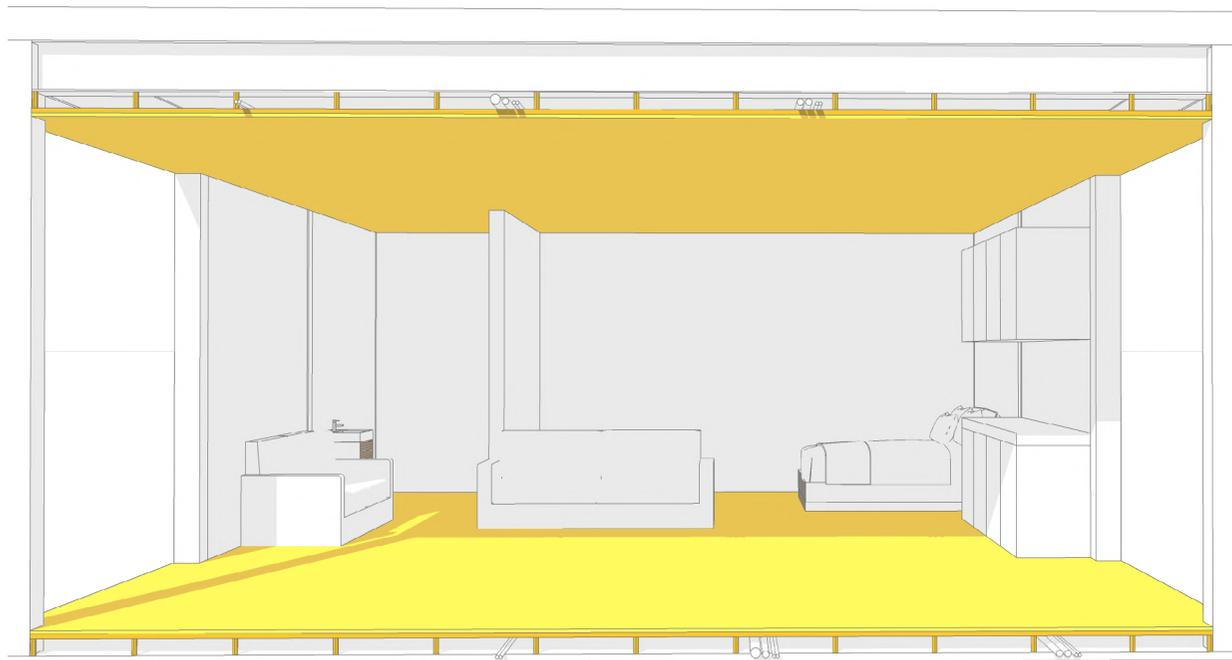
Fig 4-35: Esquema de sistema de piso y cielo raso técnico
