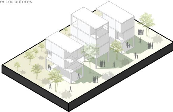
Fig 4-56: Ilustración de estrategia de conformación de plazas y estancias en geometría paralela
