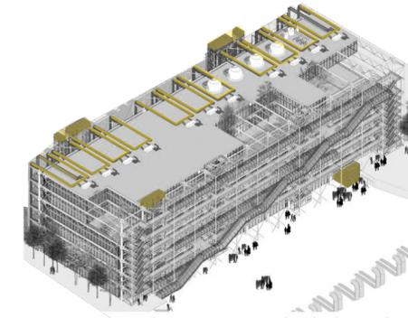
Fig 1- 20: Isometría Centro pompidou (Sistema centralizado de Instalaciones )
