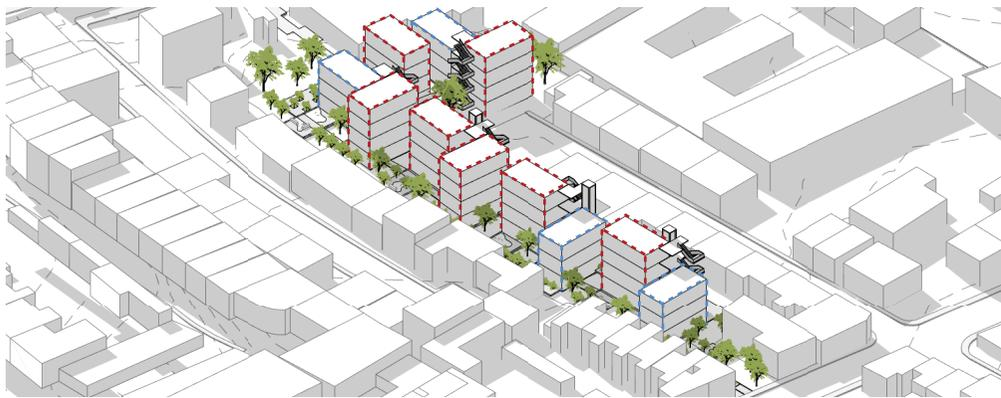
Fig 4-76: Axonometría general esquemática de altura solar de bloques e incidencia 9 am
