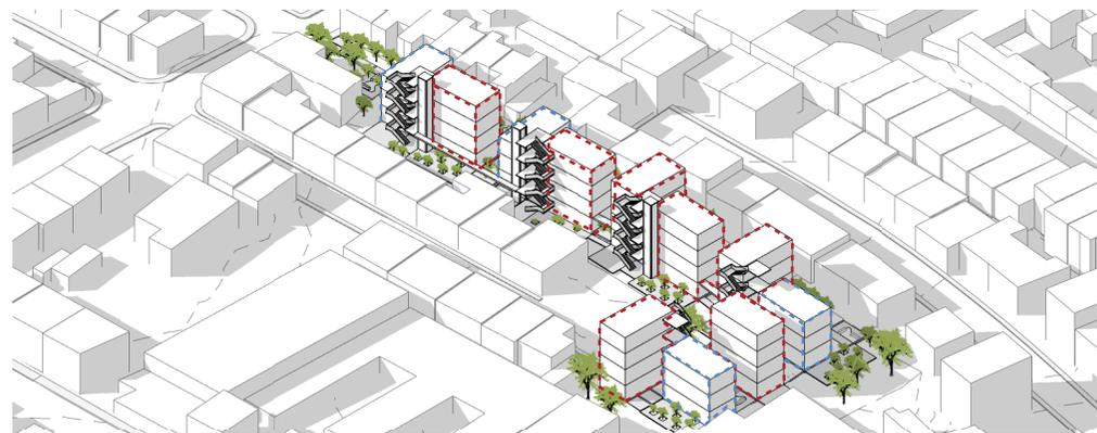
Fig 4-75: Axonometría general esquemática de altura de bloques e incidencia solar 4 pm
