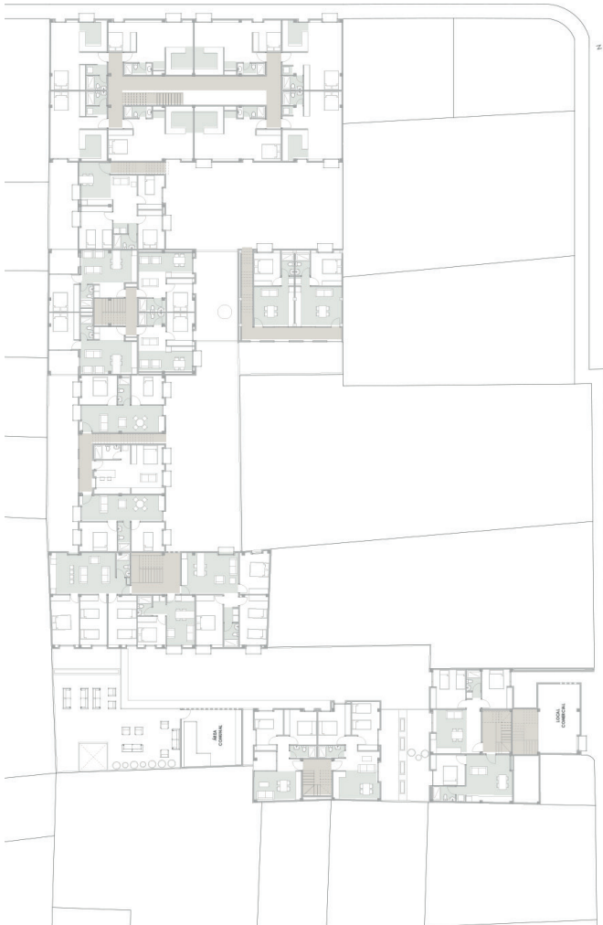
Figura 139: Mapa de zonas húmedas y conexiones Primera Planta Alta, Anteproyecto Fuente: Autores, 2022
