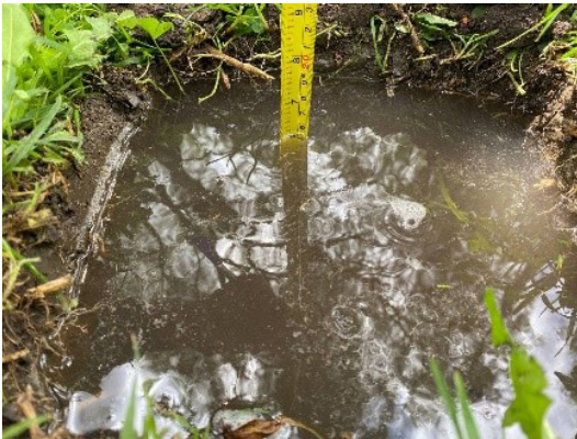
Figura 3.16 Prueba de infiltración básica.
