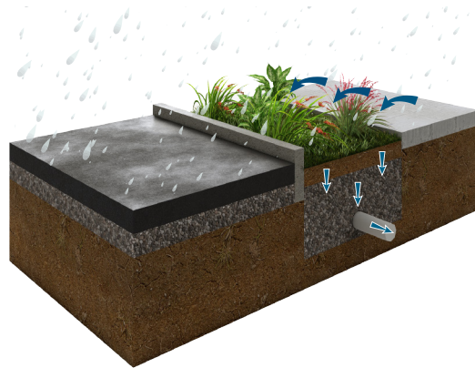
Figura 2.14 Jardín de infiltración completa.
