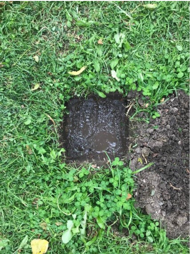
Figura 3.17 Finalización de prueba de infiltración básica.
