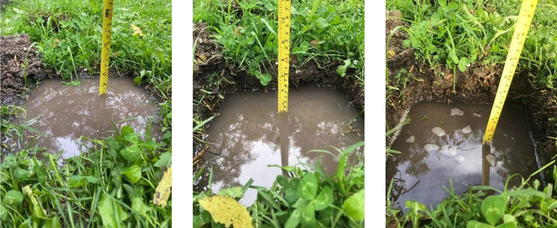
Figura 3.18 Prueba de infiltración detallada – Datos.
