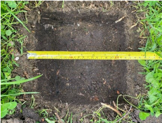
Figura 3.15 Excavación para prueba de infiltración básica.
