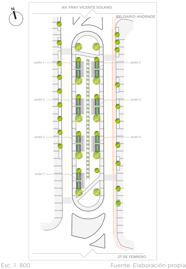
Figura 4.14 Emplazamiento SUDS tramo 05.
