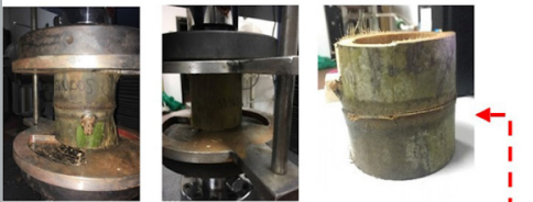
16 La falla de estas probetas se manifiesta mediante fisuras verticales en los lugares donde estuvo apoyado el elemento.
