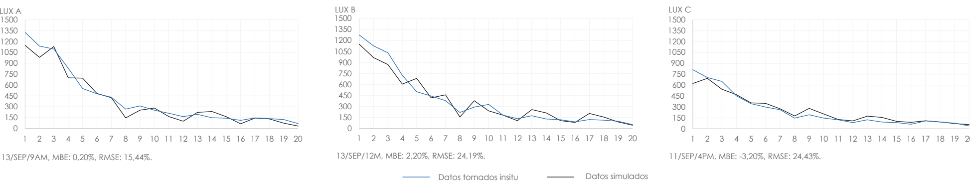
Figura 55. Diagrama de iluminancia en días específicos (datos insitu y simulados tomados en cuenta para validación de modelo 3d).
