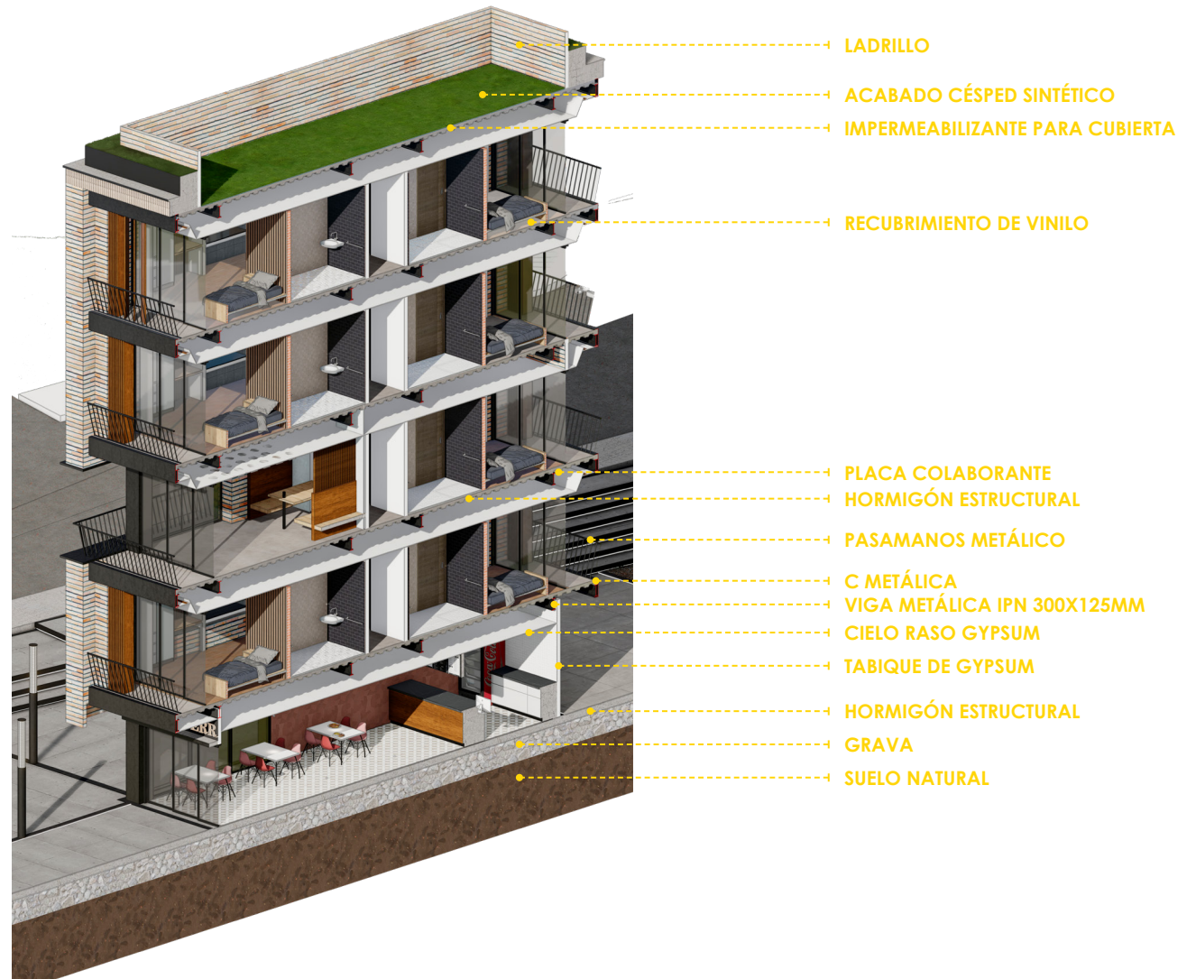
G5_27 Axonometría constructiva
