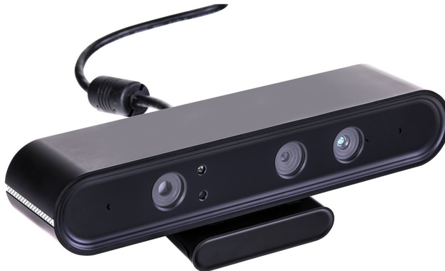
Figura 3.4: Cámara de profundidad Orbbec Astra Pro, seleccionada para el seguimiento de esqueleto.
