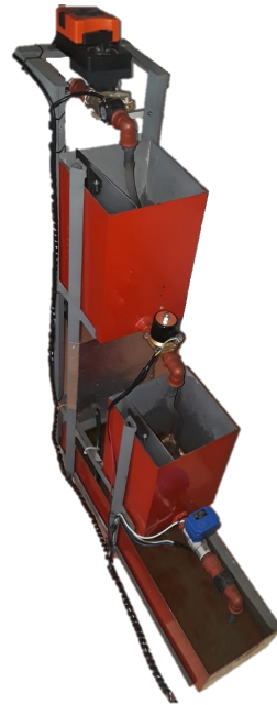
Figura 5.13: Sistema multitanque construido.
