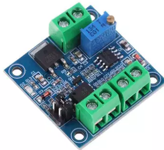
Figura 4.33: Convertidor de PWM a voltaje analógico 0-10V. Imagen tomada de [12].
