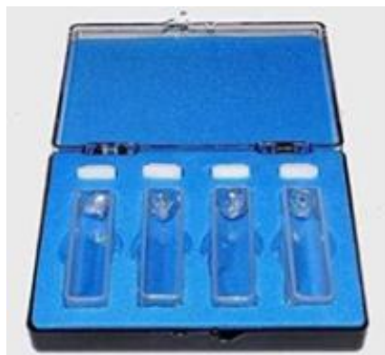
Figura 20. Celdas de cuarzo de la marca Lifestyle Vision utilizado en el fotómetro U-V.
