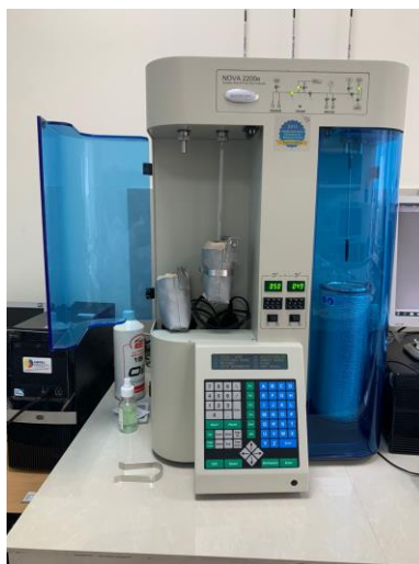
Figura 16. Equipo Quantachrome Nova 2200E utilizado para determinar por el método BET el área específica de los adsorbentes.
