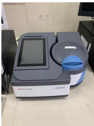
Figura 19. Equipo Espectrofotómetro UV-Vis marca Genesys 180 utilizado para determinar las muestras sintéticas.
