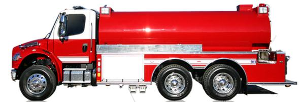
FIGURA 13 CISTERNA O TANQUERO (V-03)
