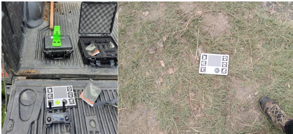
Imagen 18 Calibración radiométrica externa de la luz en tiempo real.
