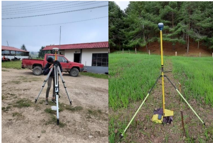
Imagen 14 Calibración y colocación de GNSS estático (izquierda) y toma de puntos con el GNSS relativo o móvil (derecha).
