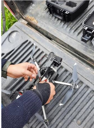
Imagen 16 Montaje de cámara y sensor de luz al dron Mavic Pro
