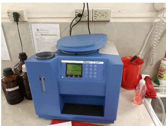
Anexo 3. Bomba calorímetra IKA modelo C200
