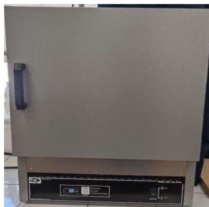
Anexo 2. Secado de muestras en la estufa.
