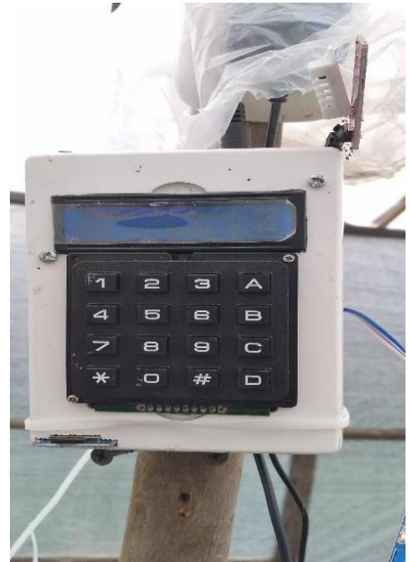
Fotografia14. Placa diseñada en el invernadero tradicional para la toma de datos.
