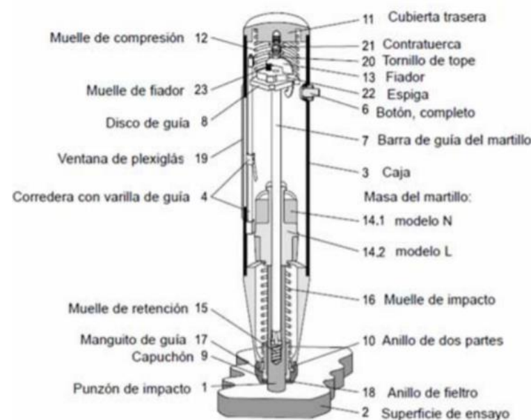
Figura 24: Sección longitudinal a través del martillo mostrando sus componentes Lozano, 2014
