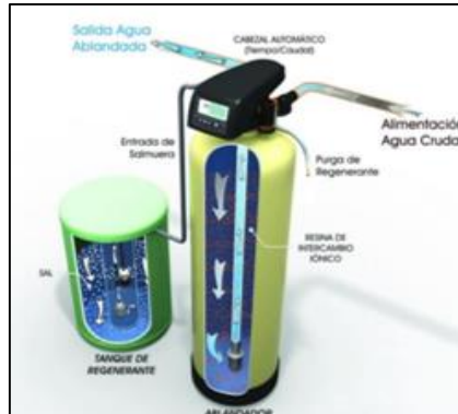
Imagen 12. Componentes del ablandador de agua
