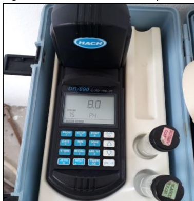
Imagen 16. Determinación de pH in situ.
