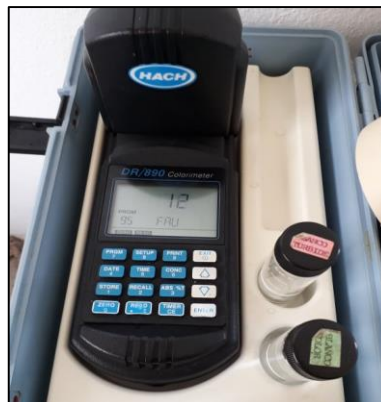
Imagen 19. Determinación de turbiedad en In Situ.
