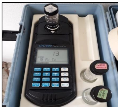
Imagen 14. Determinación de color in situ.
