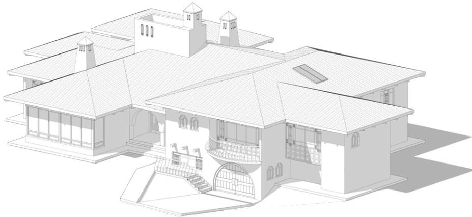
Los planos de la cubierta cambian de nivel para poder salvar el desnivel que la vivienda tiene desde su piso en nivel  $\pm 0.00$  hasta los medios pisos en los niveles  $+1.44$  y  $-1.26$  respectivamente. Formando un juego de cubiertas que cambian su forma y pendiente según la función del espacio interior.
