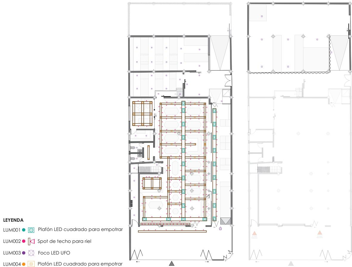
Figura 215\_ Planta de iluminación
