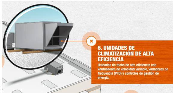
Figura 175\_ The Home Depot California. Ventilación.
