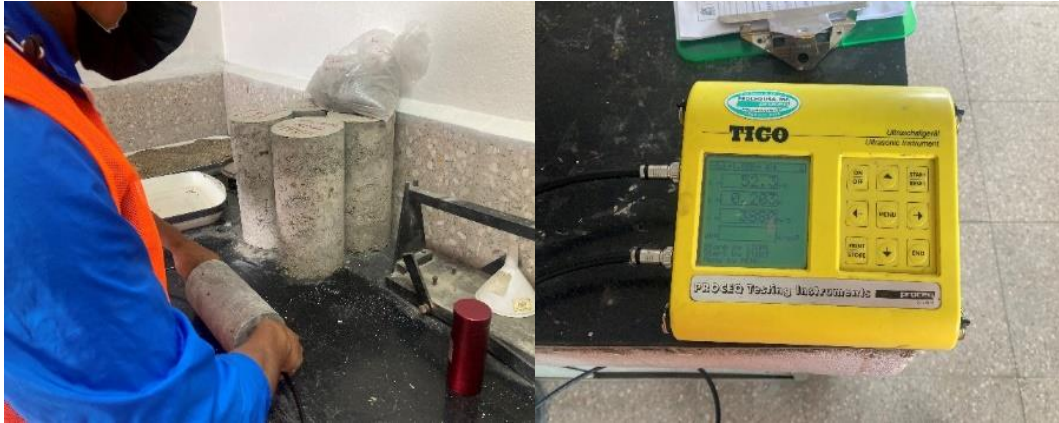
Figura 25: Ensayo de Ultrasonido en laboratorio
