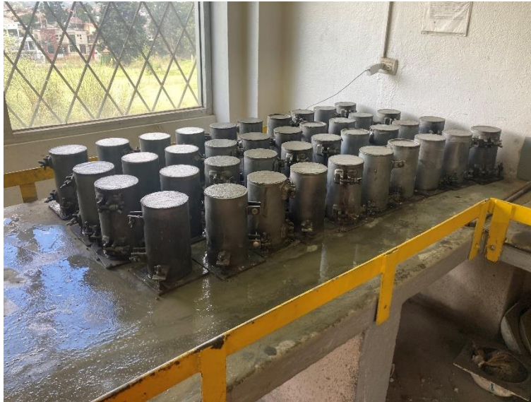
Figura 13: Probetas cilíndricas (10cm diámetro y 20cm de altura)
