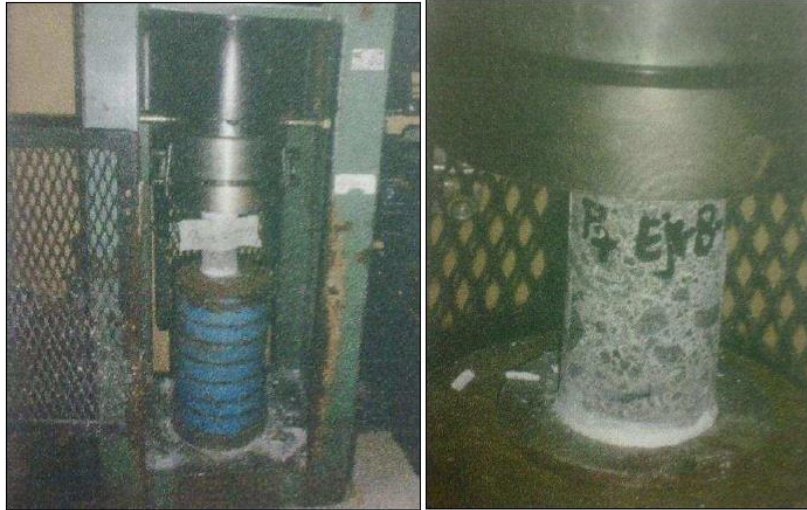
Figura 10: Ejecución del ensayo de compresión
