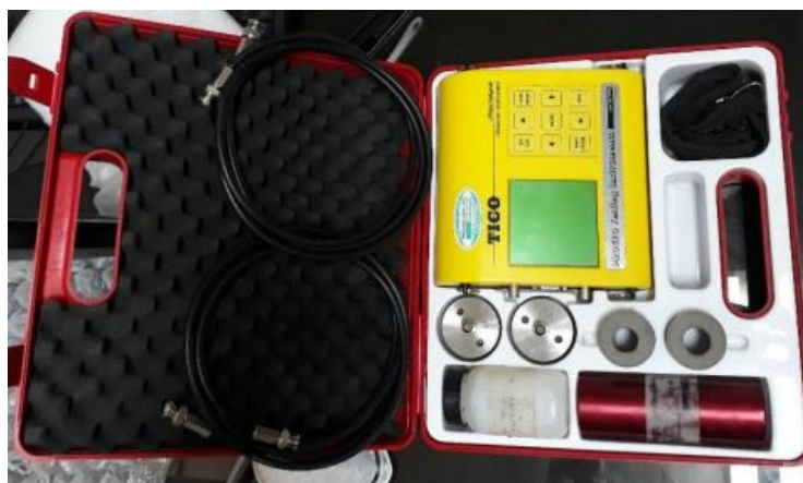
Figura 23: Equipo de ultrasonido TICO PROCEQ
