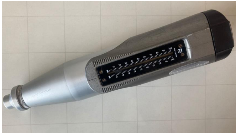
Figura 17: Equipo de esclerometría NOVATEST
