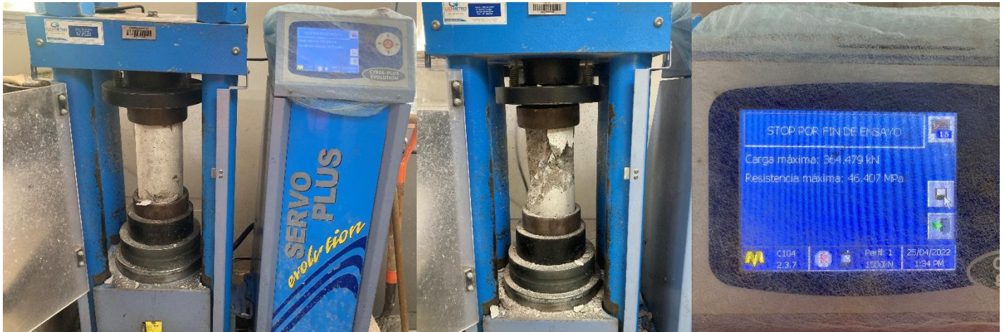
Figura 22: Rotura de cilindros a compresión
