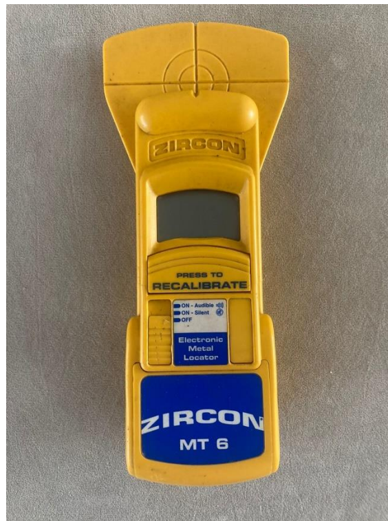
Figura 18: Detector de Armaduras ZIRCON MT 6
