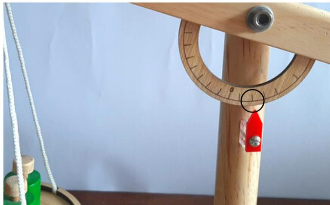
**I)** Quitar dos masas del platillo derecho de la balanza y pedir a los estudiantes que observen el cambio en la posición tanto en la regla graduada, así como en la inclinación de la balanza.
