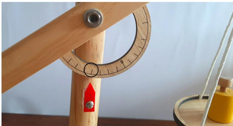
**C)** Agregar 3 masas de un color diferente en el platillo derecho de la balanza y pedir a los estudiantes que observen la nueva posición que se marca en la regla graduada, así como la nueva inclinación de los platillos de la balanza.
