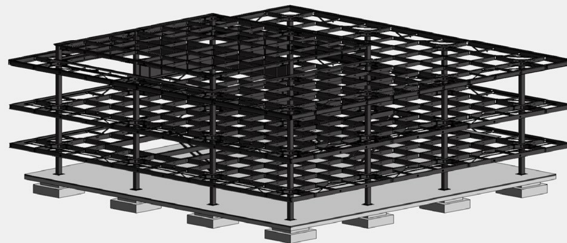
Axonometría estructura de acero + entramados de madera
