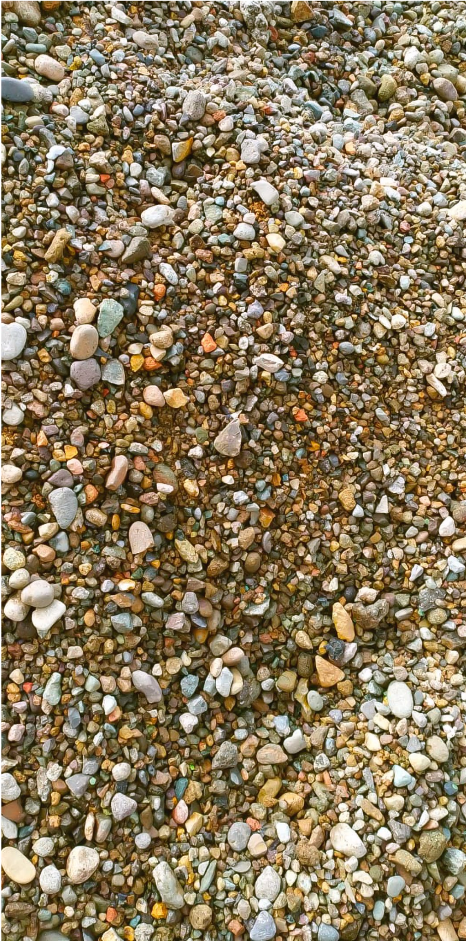
Imagen 31: Agregado grueso (gravilla) a usar en el hormigón con fibra Fuente: Captura propia
