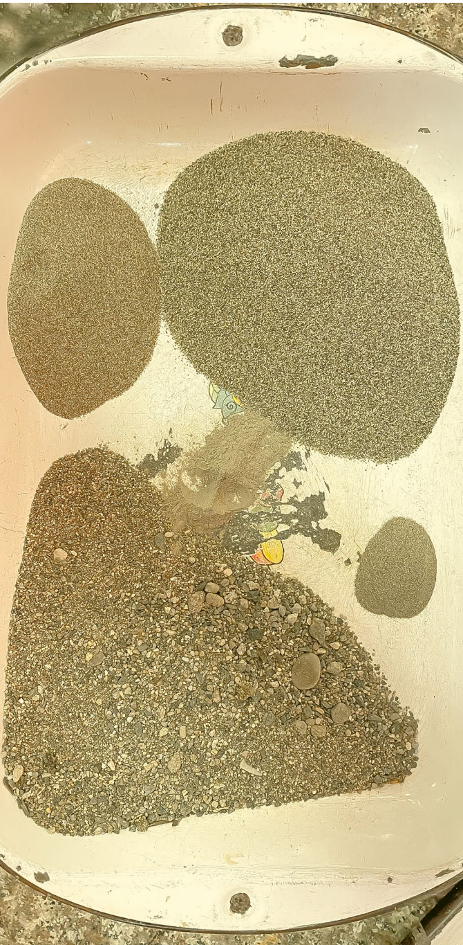
Imagen 30: Granulometría de la arena a usar en el hormigón con fibra de bagazo Fuente: Captura propia
