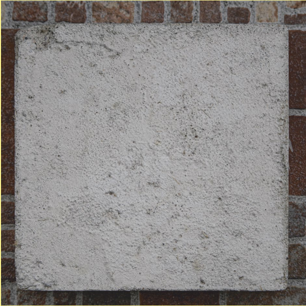
Imagen 48: Muestra de 15x15 cm, hormigón con 2,5% de fibra Fuente: Captura propia
