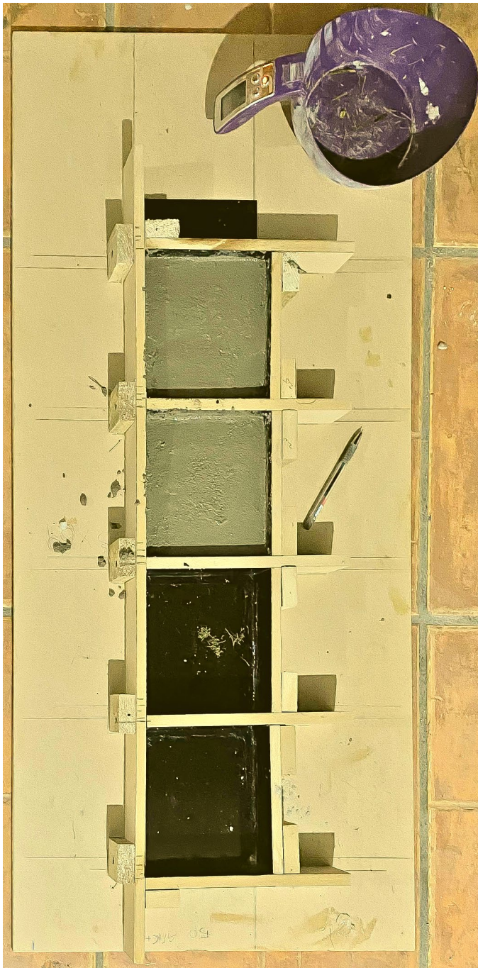
Imagen 34: Fundición de placas de hormigón de 15x15x3,5cm Fuente: Captura propia
