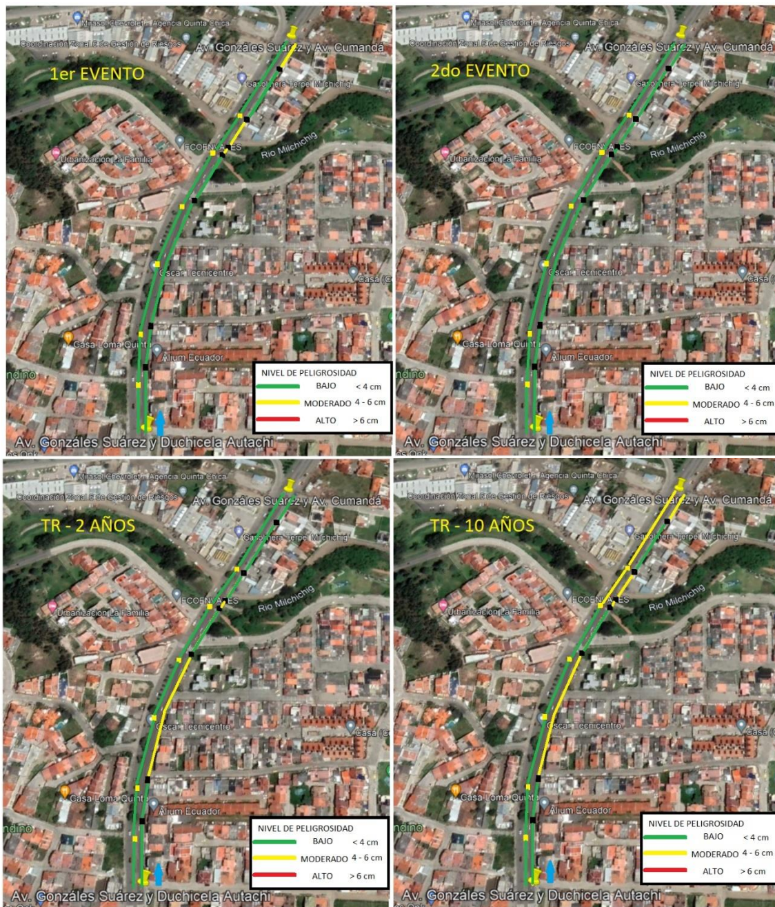
Ilustración 38. Nivel de riesgo según CLABSA (2006) para Pendiente Plana en condición actual con reja comercial.
