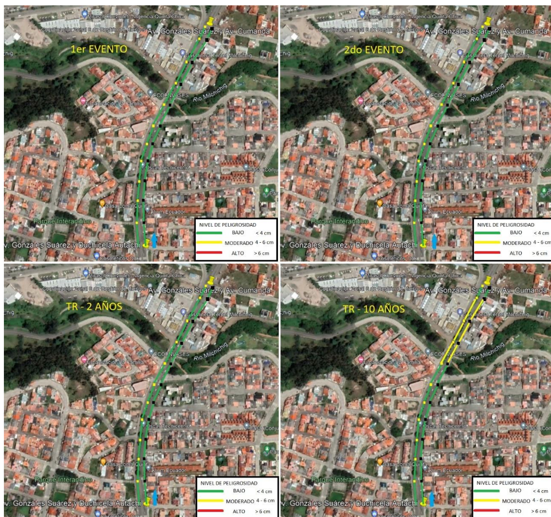
Ilustración 43. Nivel de riesgo según CLABSA (2006) para Pendiente Plana en condición optimizada con rejas actuales.
