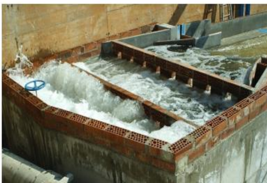
Ilustración 21. Depósito de cabecera de la plataforma e individuo en ensayo. (Gómez M., Russo B. 2010)
