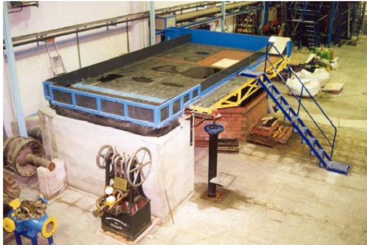
Ilustración 20. Plataforma de ensayo para rejas. (Gómez, M. 2007)
