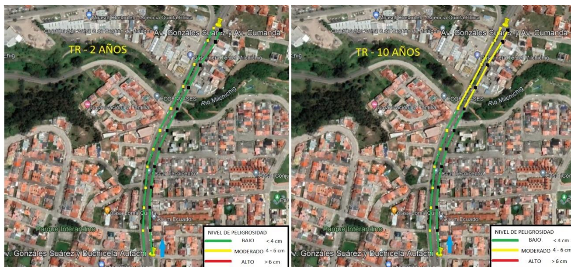
Ilustración 56. Nivel de riesgo según CLABSA (2006) para Pendiente Plana en condición optimizada para reja actual con 30% de obstrucción.
