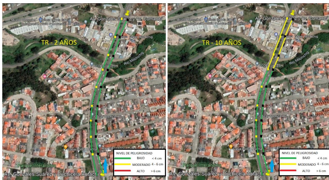
Ilustración 57. Nivel de riesgo según CLABSA (2006) para Pendiente Plana en condición optimizada para reja comercial con 30% de obstrucción.
