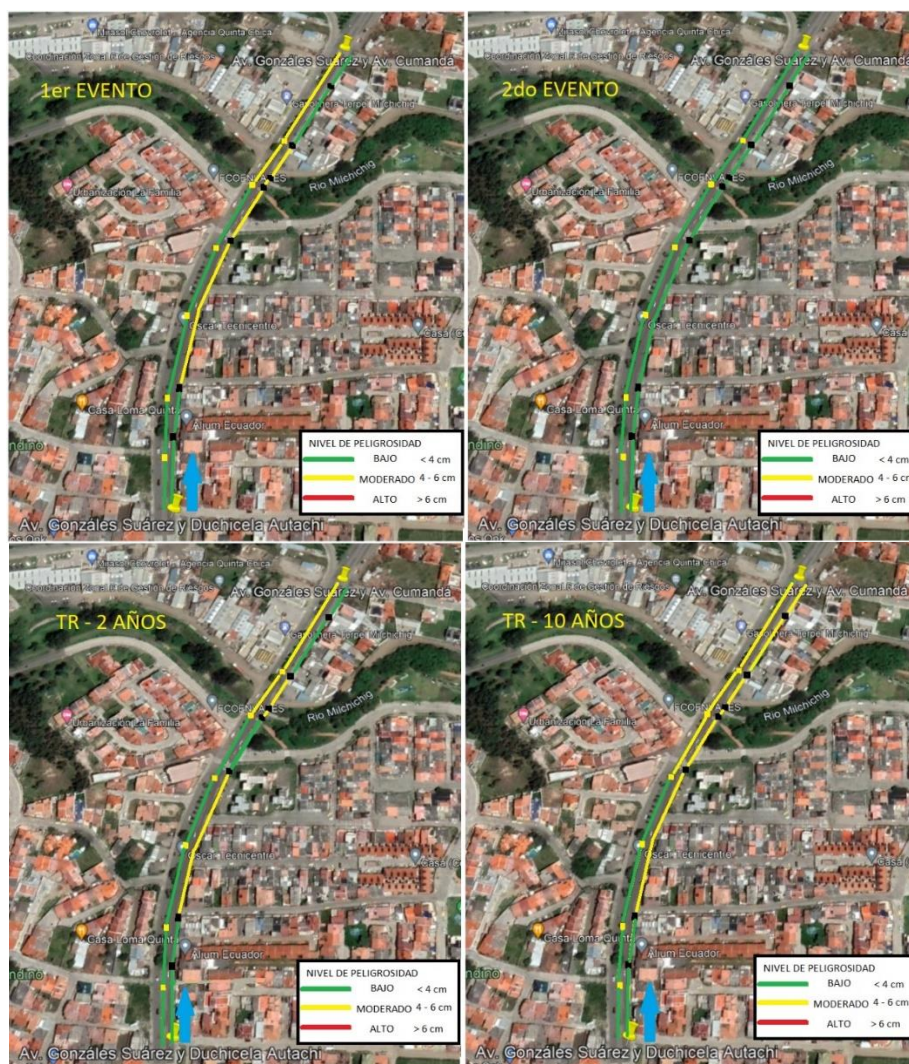
Ilustración 34. Nivel de riesgo según CLABSA (2006) para Pendiente plana en condición actual.
