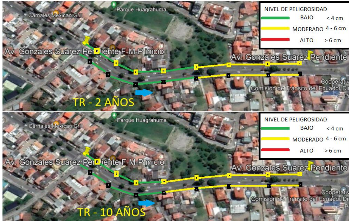
Ilustración 60. Nivel de riesgo según CLABSA (2006) para Pendiente F-M-P en condición optimizada para reja actual con 30% de obstrucción.
