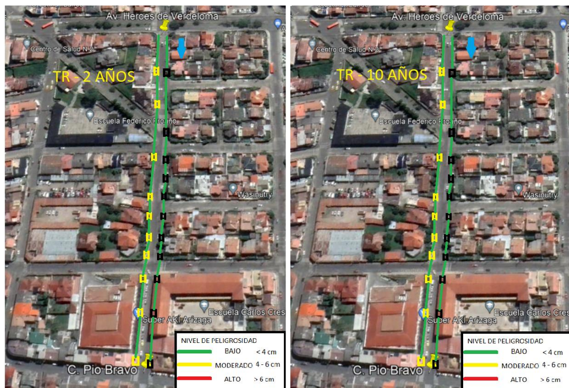
Ilustración 55. Nivel de riesgo según CLABSA (2006) para Pendiente M-M-P en condición actual con 30% de obstrucción.
