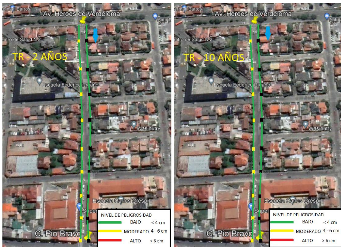
Ilustración 63. Nivel de riesgo según CLABSA (2006) para Pendiente M-M-P en condición optimizada para reja comercial con 30% de obstrucción.
