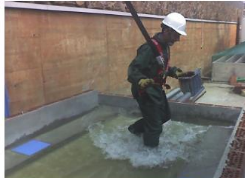
Ilustración 21. Depósito de cabecera de la plataforma e individuo en ensayo. (Gómez M., Russo B. 2010)
