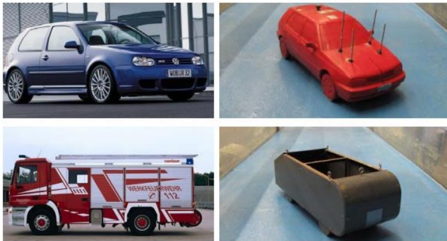
Ilustración 22. Vehículos ensayados, prototipos a la izquierda y modelo a la derecha. (Gomáriz, M., Gómez, M., Russo, B. 2016)
