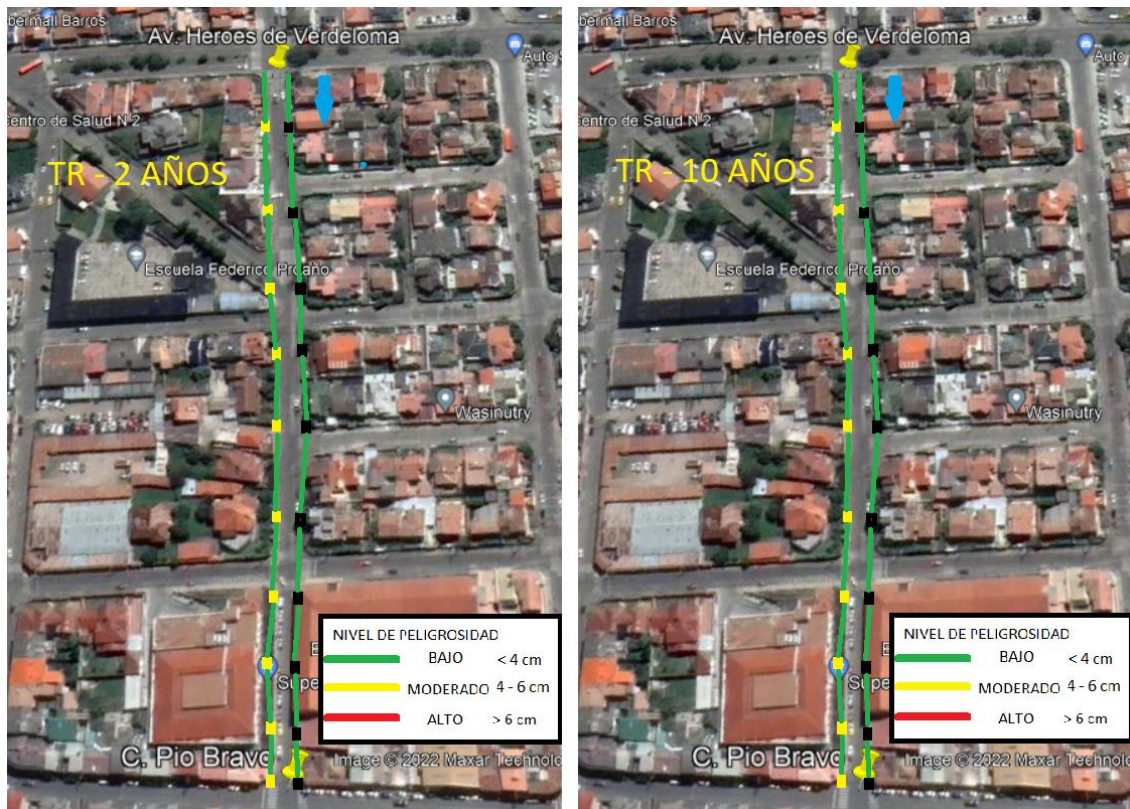
Ilustración 62. Nivel de riesgo según CLABSA (2006) para Pendiente M-M-P en condición optimizada para reja actual con 30% de obstrucción.
