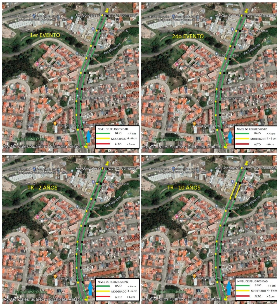
Ilustración 48. Nivel de riesgo según CLABSA (2006) para Pendiente Plana en condición optimizada con reja comercial.
