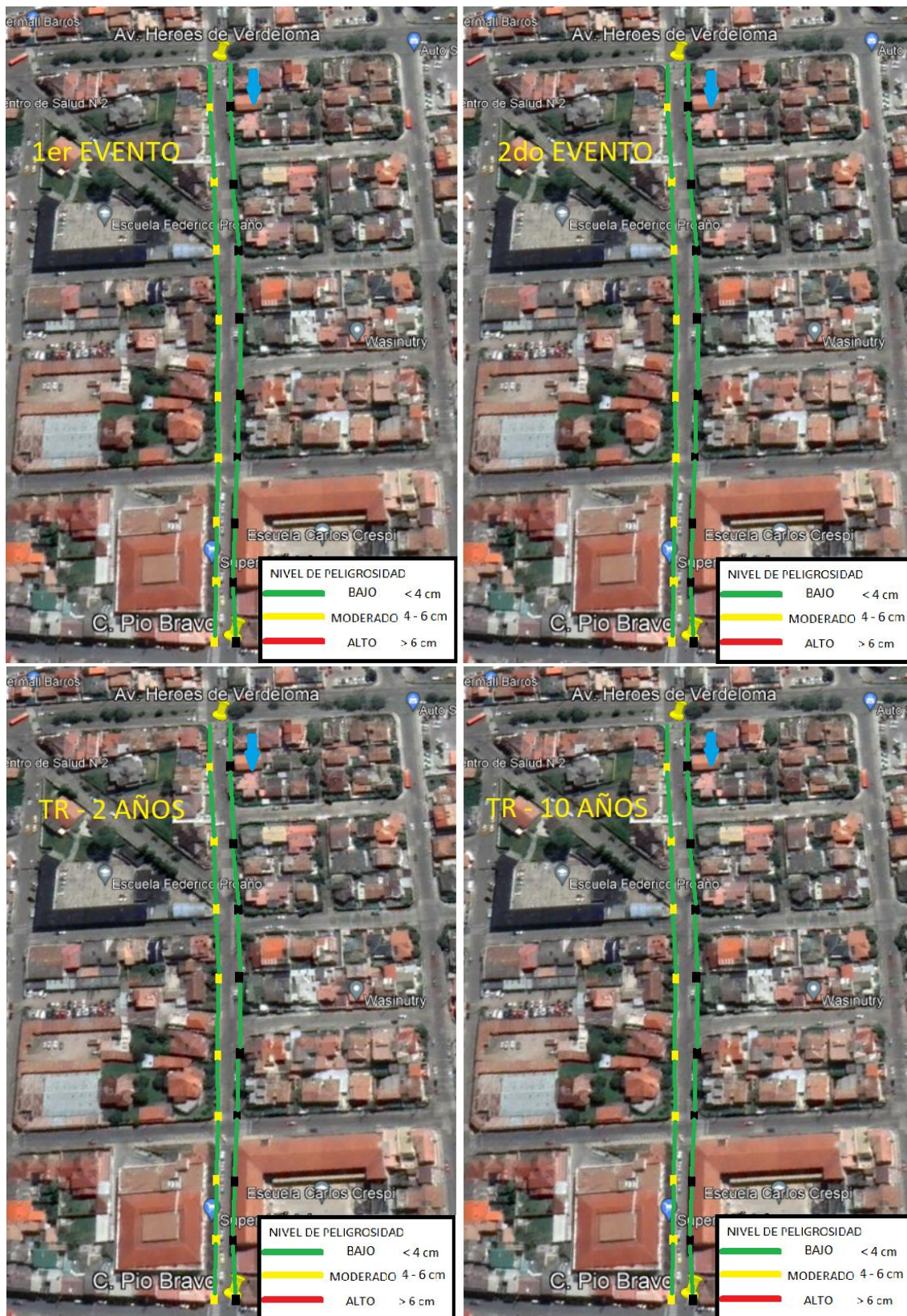
Ilustración 51. Nivel de riesgo según CLABSA (2006) para Pendiente M-M-P en condición optimizada con reja comercial.
