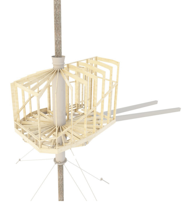
Figura 261: Armado Constructivo 1. Ilustración: Helen & Hard(2020)
