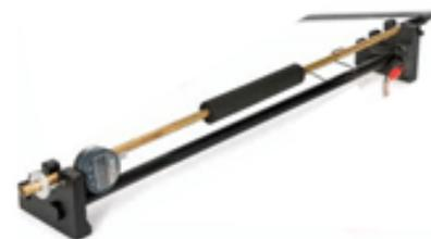
Nota. Aparato de expansión térmica modelo TD-8578. [Imagen]. por TecnoEdu. <https://tecnoedu.com/Pasco/TD8856.php>
