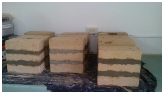
Figura 1. Elaboración de los muretes
