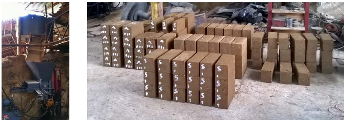
Figura 1. Máquina para fabricar bloque prensado y muestras de bloque prensado
