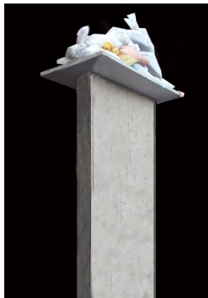
Figura 21 – Prueba de rotura con sacos de arena
