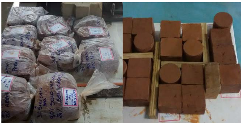
Figura 2. Amostras em cura em saco plastico até o terceiro dia após remoção
