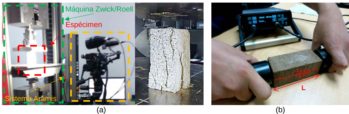
Figura 3. Adobe de Huaca de la Luna, ensayos de caracterización mecánica: (a) configuración del ensayo a compresión y falla típica en prisma sometido a compresión; y (b) procedimiento de ensayo de ultrasonido
