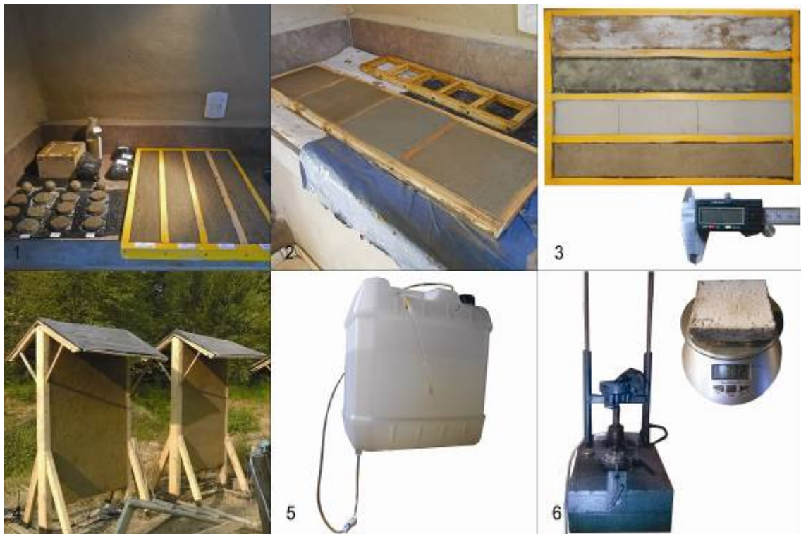
Figura 2. Dispositivos de ensayo: 1) Ensayos sensoriales; 2) Moldes para probetas; 3) Cajón de Alcock y calibre electrónico; 4) Bastidores; 5) Tanque capacidad 10 litros; 6) Máquina con cepillo metálico y balanza electrónica.
