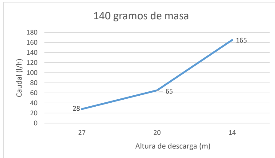
Figura 19: Caudal alcanzado para 140 g de masa, con cámara de aire de 3 L y 3 m de carga.
