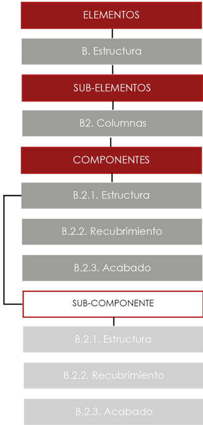
Fig 73. Sistema de referencia, ejemplo: estructura-columnas. Fuente: Proyecto VliR CPM, 2016. Atlas de Daños. Edificaciones Patrimoniales de Cuenca. Elaboración: Propia, 2020.
