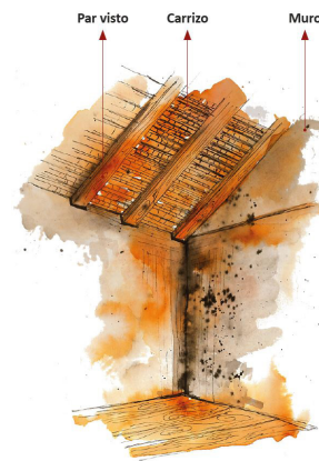
Fig 49. Cielo raso con pares vistos. Fuente: Merchán Ana María, 2019. Recuperado de: Glosario gráfico: Detalles constructivos y toponimias de viviendas vernáculas patrimoniales y sus variantes dentro del manzano de la iglesia de San Francisco y sus inmediatas.
