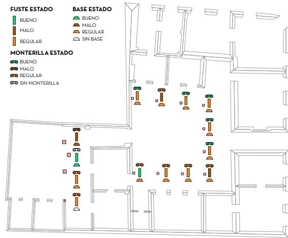
Fig 183. Estructura-columnas de planta baja: estado. Elaboración: Propia, 2020.
