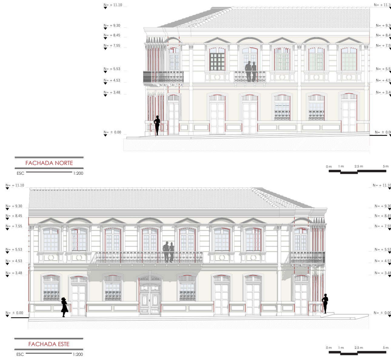
Fig 129. Fachada norte y fachada este, estado actual. Elaboración: Propia, 2020.
