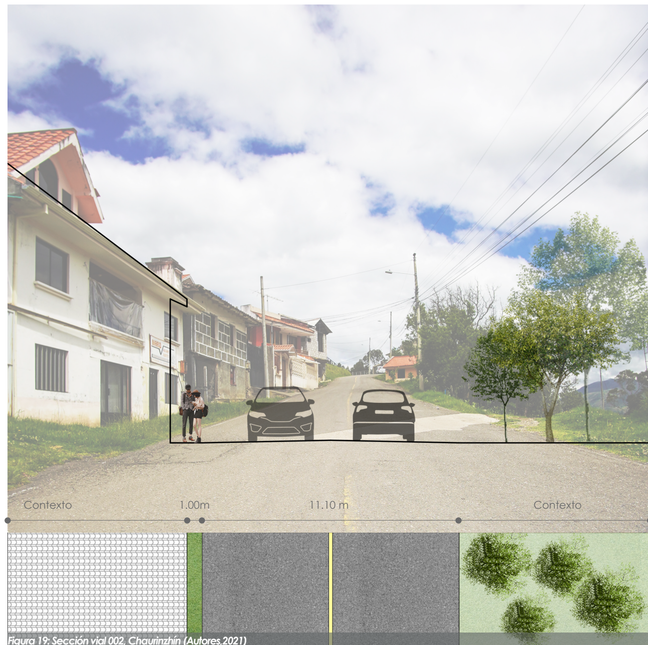
Figura 19: Sección vial 002, Chaurinzhín (Autores, 2021)
