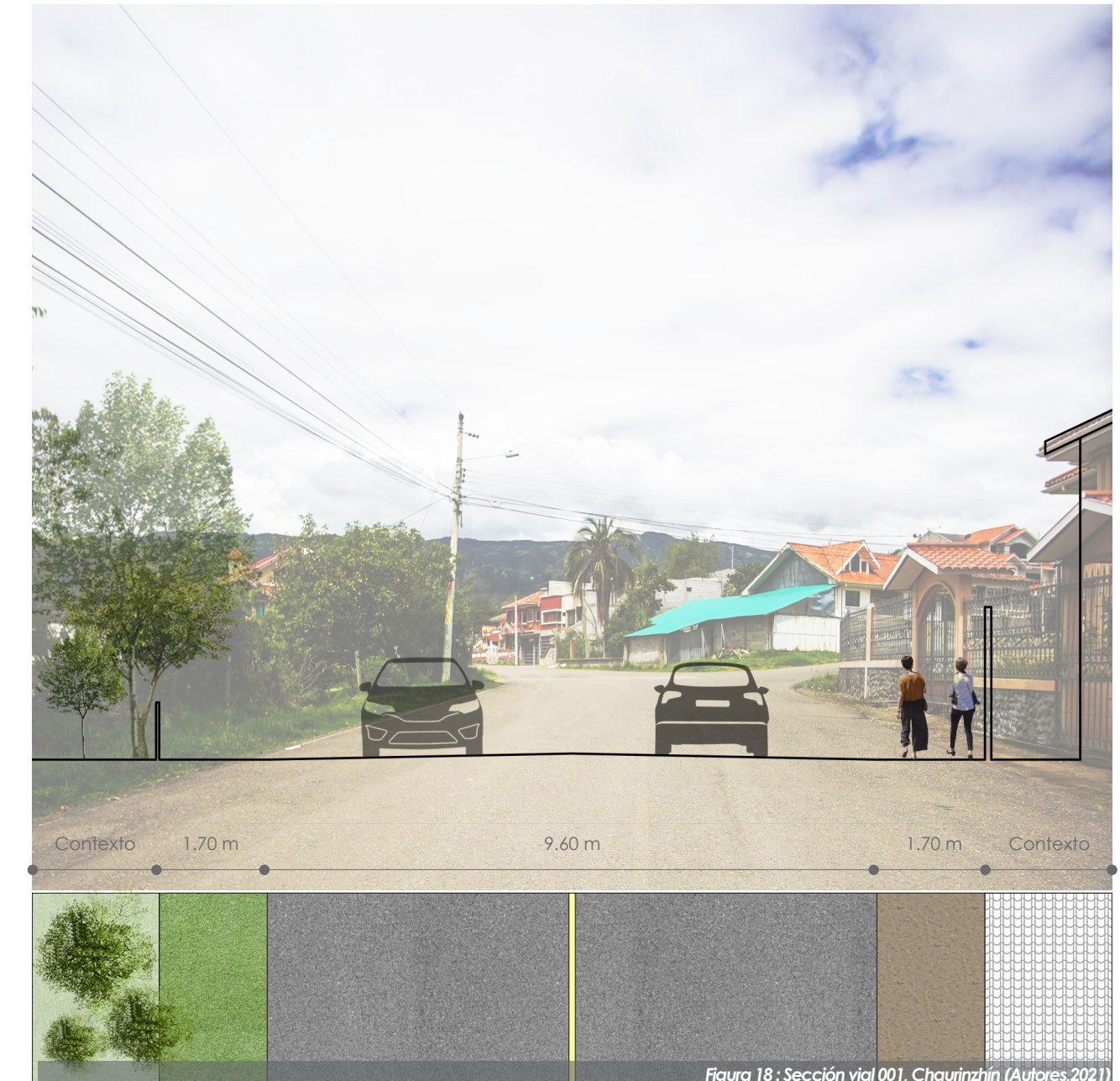
Figura 18: Sección vial 001, Chaurinzhin (Autores, 2021)
