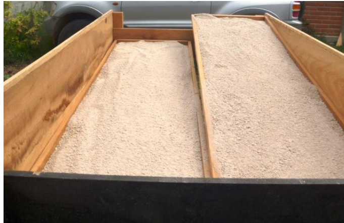
Fig. 85: Zeolita colocada en la base del secador solar, fuente propia
