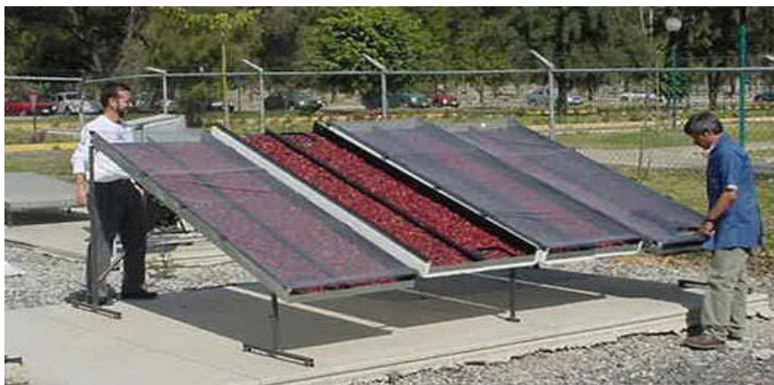
Fig.18: Secador solar directo.
