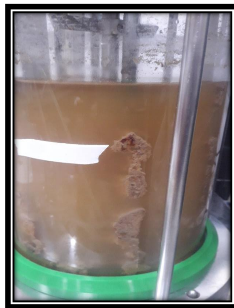
Ilustración 26 Proceso de fermentación con células inmovilizadas
