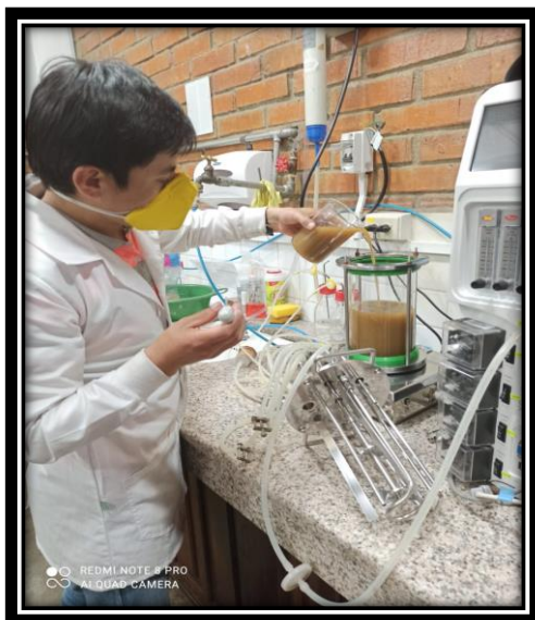
Ilustración 25 Adición del mucílago de cacao en el reactor y ajuste parámetros de fermentación
