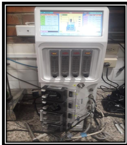
Ilustración 25 Adición del mucílago de cacao en el reactor y ajuste parámetros de fermentación
