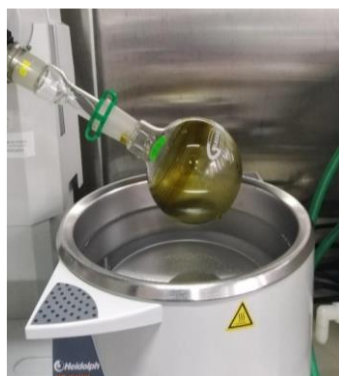
Ilustración 14 Proceso de concentración y colocación de la primera fracción. Fuente: Propiedad de los autores.
