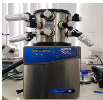
Ilustración 18 Proceso de obtención de extractos metanólicos: Liofilización. Fuente: Propiedad de los autores.
