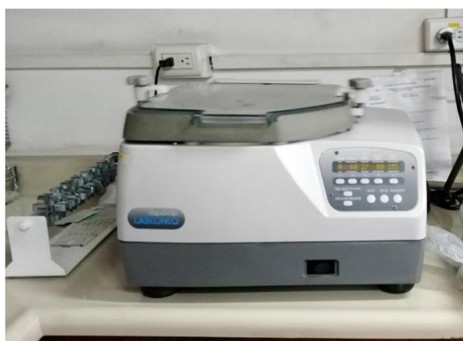
Ilustración 20 Proceso de obtención de extractos clorofórmicos: Concentración al vacío.
