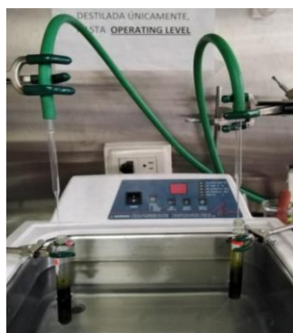
Ilustración 16 Proceso de concentración. Eliminación de solvente con nitrógeno gaseoso. Fuente: Propiedad de los autores.
