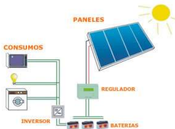
Figura 2-4: Instalación Fotovoltaica Básica.
