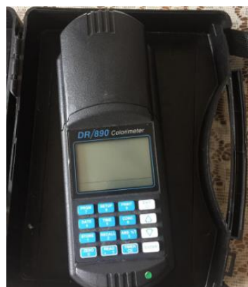
Figura 43: Colorímetro HACH DR/890. Fuente: Méndez & Trelles (2021).
