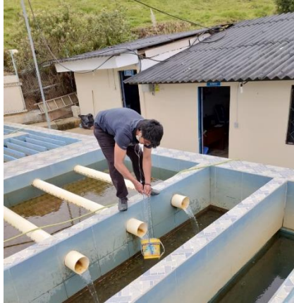
Figura 44: Medición de caudal por aforo volúmetrico. Fuente: Méndez & Trelles (2021).
