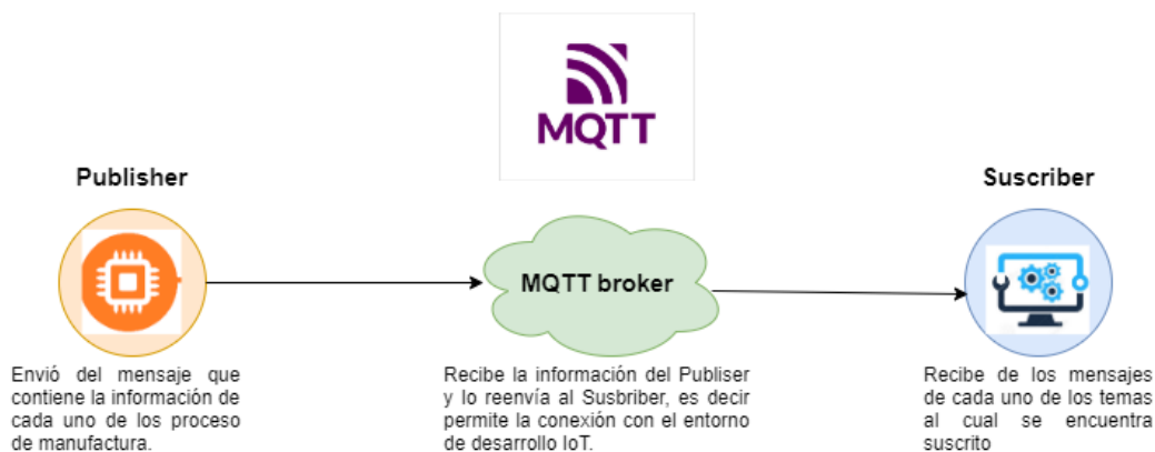
Figura 2.7: Diagrama de funcionamiento del protocolo MQTT.
