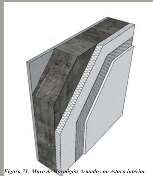
Figura 31: Muro de Hormigón Armado con estuco interior
