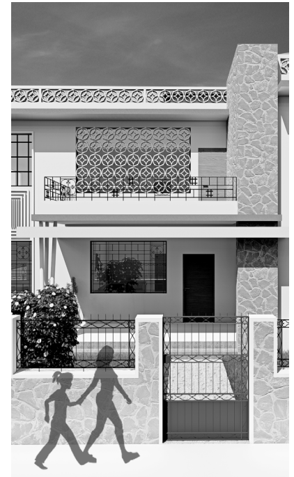
181. Vista de ventana con elementos de cobogó- cerramiento con marcos de hierro, y ventanas de hierro y vidrio / Fuente: El autor
