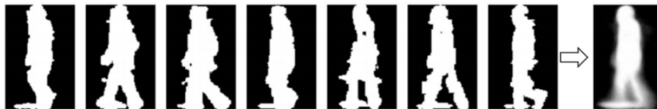
Figura 2.11: Siluetas binarias de la marcha condensada en GEI [32]
