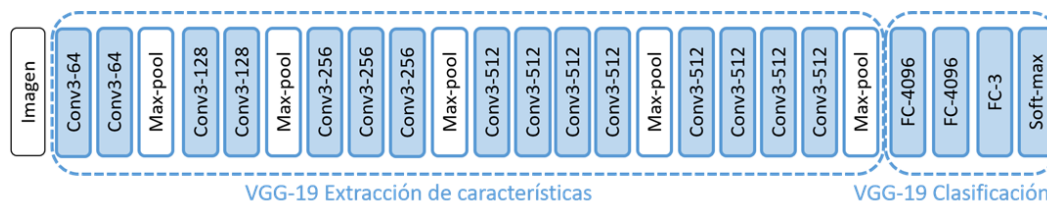
Figura 3.13: Arquitectura de la variación del modelo VGG-19
