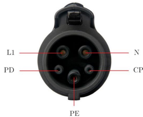
Fig. 2. 9. Diagrama de pines del conector SAE J1772.
