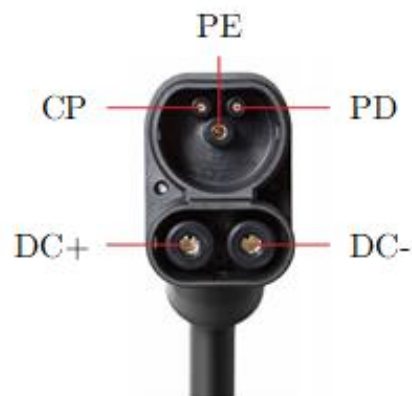
Fig. 2. 17. Diagrama de pines de un conector CCS2.
