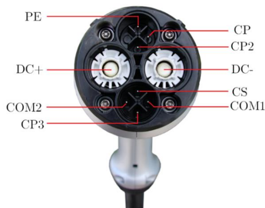
Fig. 2. 20. Diagrama de pines del conector CHAdeMO.
